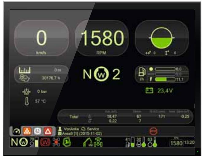
Im MMS-angepassten (Mensch-Maschine-Schnittstelle) Arbeitsmodus zeigen verschiedenen Registerkarten die laufende Produktion, die Betriebsinformationen, Maschinenalarme uvm. an. Außerdem überzeugt der moderne Arbeitsmodus mit Farbwahl, Kontrasten sowie Platzierung
