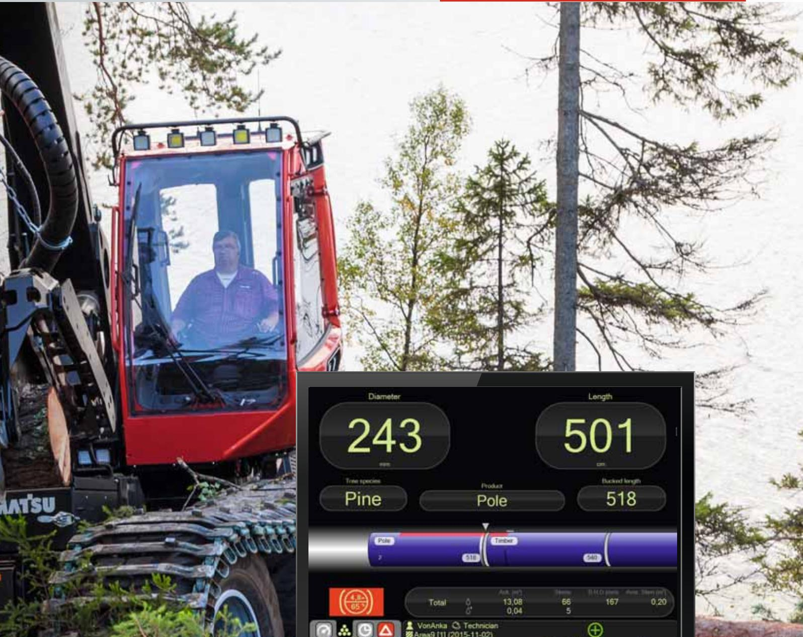
Betrieb und Stammdaten enthalten alles, was für einen vollständigen Beleg erforderlich ist. Zudem steht ein separater Produktionsbericht zur Verfügung, der über jeden geernteten Abschnitt mit Volumen, Länge, Durchmesser, Klassifizierung usw. informiert.
